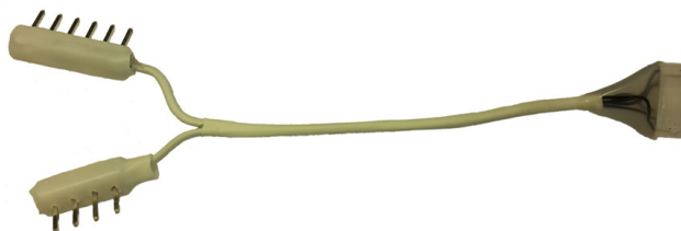
Рисунок 5 – Внешний вид кабеля программирования ИПП КФСТ.425539.001.301.
